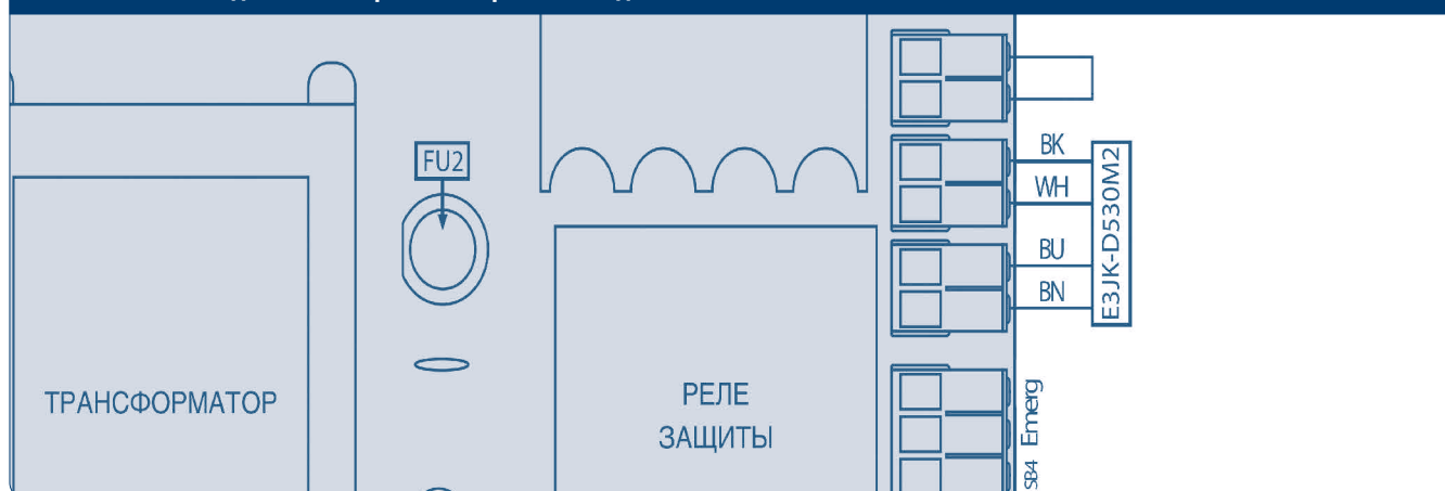
Рис. 5.3. Схема подключения фотозлектрического датчика
